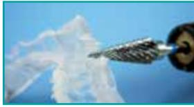
**2.** Grind the borders with the tungsten carbide bur (> 20 000 rev./min.).
