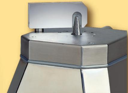
La visera de protección de la fresa evita posibles daños en las personas cuando la máquina se deja en funcionamiento por descuido. Durante el trabajo, su suave accionamiento no supone ningún estorbo.
