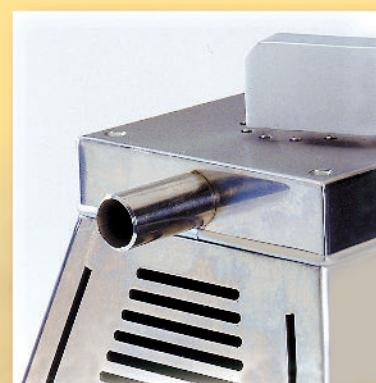
Un tubo situado en la parte posterior de la mesa de trabajo permite la salida del polvo generado. La máquina se suministra con un adaptador de nylon para diámetro de tubo de aspiración de 35 mm.
