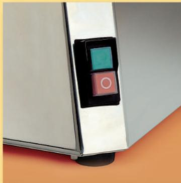
Interruptor de seguridad acorde a la normativa de Seguridad en Máquinas.
