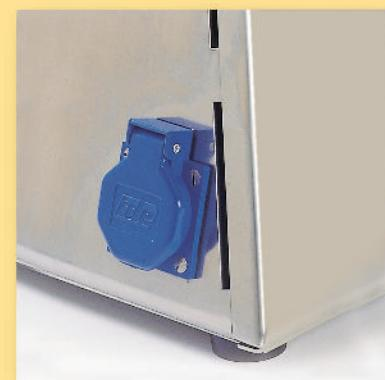
En la parte trasera de la máquina se encuentra una práctica toma de corriente a la que se puede conectar una unidad de aspiración exterior que se pondrá en funcionamiento cada vez que accionemos el interruptor principal de la recortadora de interiores.
