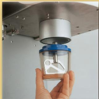
La colocación de la taza en la máquina se realiza mediante un acoplamiento a 12 caras, resultando sencillo encontrar la posición de encaje. Además, las juntas de estanqueidad están fabricadas en un elastómero blando, para minimizar la presión que debe ejercer el usuario en la maniobra de encaje. Bastan unos pocos segundos para que la taza quede firmemente sujetada a la batidora.
