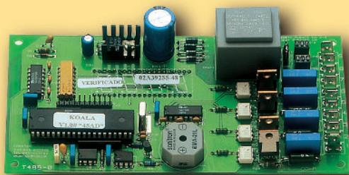
Todas las funciones de la batidora de vacío Koala se encuentran gobernadas por un control dotado de microprocesador.
