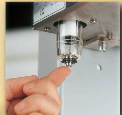
En caso de parada de la batidora de vacío por corte en la red de suministro eléctrico, es posible soltar la taza del cuerpo de la batidora (maniobra de emergencia), actuando manualmente sobre la válvula de descarga situada en la carcasa del filtro.
