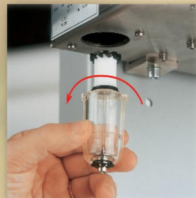
La sustitución o limpieza del elemento filtrante resulta sencilla. El acceso es inmediato, y no es necesario desmontar la máquina o emplear ningún
