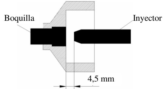
Si la boquilla se soltase, péguela al portaboquillas con cianocrílico. La boquilla debe quedar al ras de la superficie interior del portaboquillas, para asegurar que la distancia del inyector a la boquilla es de 4.5 mm y se produce correctamente el efecto Venturi.
