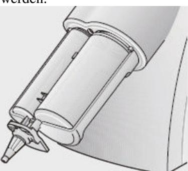
8. Für den Start und Halt der Materialeinspritzung in den Abdrucklöffel die Vorlauf/Halt-Taste (5) betätigen.
