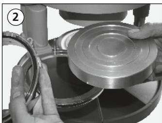
Posizionare sull'adattatore la pentola di riscaldamento e il camino, ruotando il piatto verso il centro dell'apparecchio. Contemporaneamente spingere il piatto verso il basso con una leggera pressione e impostare il riscaldamento sulla posizione di riscaldamento. Assicurarsi che il solco di guida del camino si innesti nell'alloggiamento del riscaldamento.
