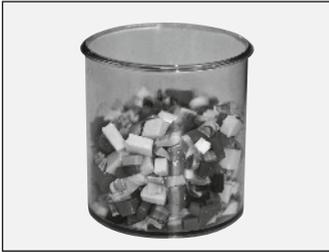
Nach Beendigung der ersten Vorwärmzeit wird das vorbereitete EVA Granulat möglichst flächendeckend in die Heizpfanne eingestreut. Die zweite Vorwärmzeit beträgt 2:30 Min. Weiter wie ab Punkt 8 beschrieben.
