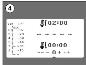
Nach Ablauf der ersten Vorwärmzeit Plattenteller ausschwenken und Heizpfanne / Kamin dem Gerät entnehmen. Anschließend die geschnittenen Drufosoft Streifen an den Schnittkanten passgenau gemäß des gewünschten Designs in die Heizpfanne einlegen, Kamin aufsetzen und wie unter Punkt 3 beschrieben erneut in das Tiefziehgerät einsetzen.
