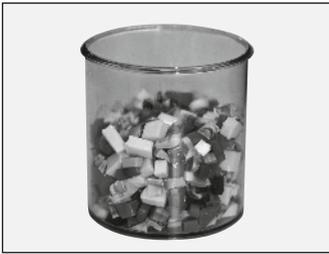
Après le premier temps de chauffe a écoulé, mettre les granules EVA préparés dans la poêle de chauffe, couvrant tout le fond de la poêle. Le second temps de chauffe dure 2 : 30 min. Suivre les instructions à partir de point 8.
