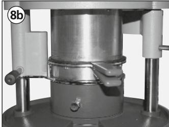
Nach Ablauf des Pressvorgangs Gerätekolben hochfahren und die Kombination Heizpfanne / Pressdeckel aus dem Gerät entnehmen.
