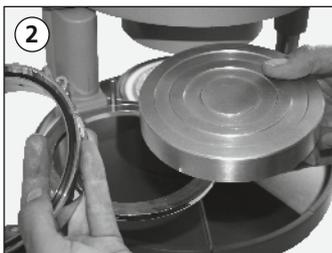
Die Heizpfanne zusammen mit dem Kamin auf den Geräteadapter positionieren und den Plattenteller in das Gerätezentrum schwenken. Den Plattenteller gleichzeitig mit leichtem Druck nach unten drücken und die Heizung in die Heizposition führen. Darauf achten, dass die Führungsrille des Kamins in das Heizungsgehäuse einrastet.
