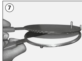
Il est recommandé de mettre le couvercle de presse premièrement sur les doigts de guidage et puis le fermer en biais, pour que l'air excédentaire puisse s'échapper.
