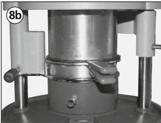
Al termine del processo di pressione, alzare il pistone dell'apparecchio e togliere la combinazione pentola di riscaldamento / coperchio da pressa dalla macchina.
