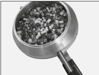
Der aktive Pressvorgang sollte für mindestens 3 Minuten gehalten werden. Bei einer unvollständigen Verbindung des Granulates ggfs. Platte wenden und einen zusätzlichen Heizprozess von 2 Min. durchführen. Weiter wie ab Punkt 8 beschrieben.
