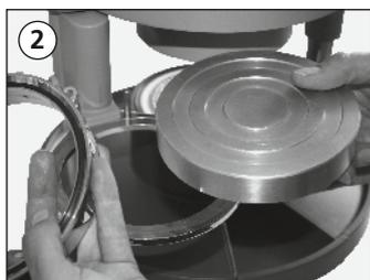
Positionner la poêle de chauffage avec la cheminée sur l'adaptateur pour la machine et pivoter le support de plaques dans le centre de la machine. En même temps, pousser le support de paques vers le bas avec une pression légère et mettre le chauffage dans la position de chauffe. Observer, que la cannelure de la cheminée s'enclenche dans la carrosserie du chauffage.
