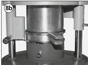
Après le processus de presse laisser monter le piston et enlever la combinaison de poêle de chauffe/couvercle de presse.
