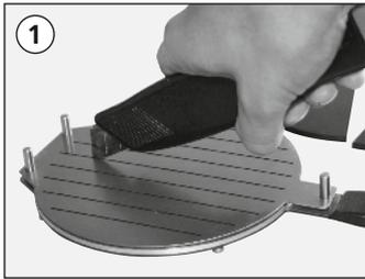
Zum Schneiden empfiehlt sich ein erwärmtes Skalpell oder Cuttermesser. So kann entsprechend der eigenen Vorstellung aus den Streifen eine neue Folie zusammengestellt werden.
